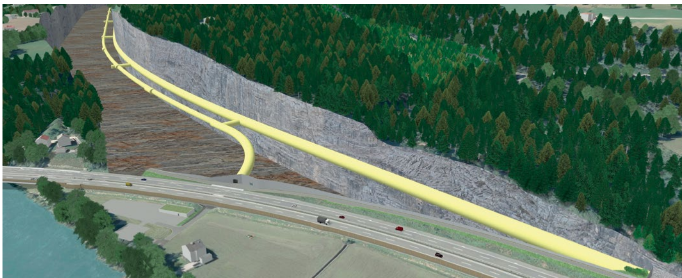
Das Allianzvertrag-Pilotmodell der ÖBB umfasst den 2,6 km langen Begleitstollen des zukünftigen zweigleisigen Angerberg-Bahntunnels.
